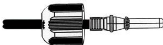
Figure4-11 Sertissez la borne métallique négative
