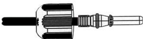
Figure3-17 Sertissez la borne métallique négative
