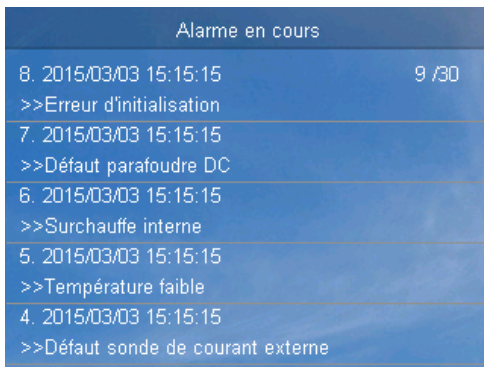
Figure4-19 Interface d'alarme active
