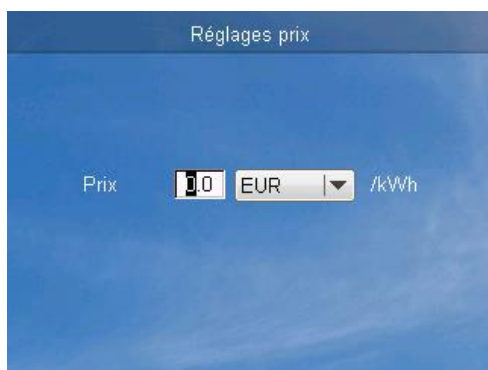
Figure4-29 Interface de paramétrage du prix de l'électricité
